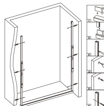
1. 首先将下轨放置在石基合适位置，与两条墙材套好。打水平，钻孔，打膨胀胶粒，将两条墙材打好螺丝固定在墙上。
