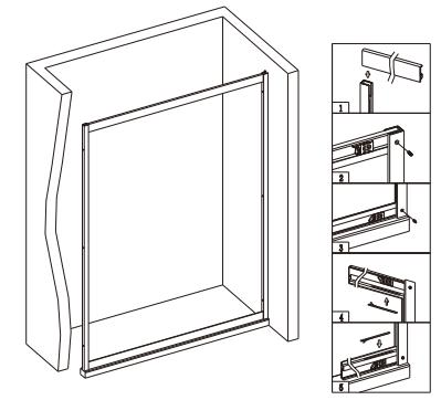
2. 将上轨放进墙材槽口，墙材上下机丝锁上，撕掉不干胶垫片的保护膜贴在轨道的固玻位置处（不干胶垫片的长度比固玻宽度短50MM即可）。
