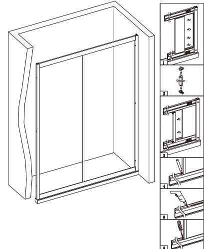
3. 将固玻放在轨道的固玻槽上，推进墙材槽内，调整至合适位置；将中柱塑件跟中柱组装好，按方向卡紧固玻，用铅笔透过塑件的孔位做记号，钻孔，用螺丝将两边的中柱跟上下轨道锁紧固定。
