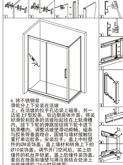
6. 将不锈钢双滑轮分上下安装在活玻上；在活玻的拉手孔边装上磁条，另一边装上F型胶条，软边朝房体外面；将装好滑轮和胶条的活玻抬起挂在上轨滑槽内，按下下轮的弹跳按钮将下轮卡进下轨滑槽内，调整活玻使滑动顺畅，磁条与胶条等垂直吻合。固玻与墙材接触位置打单边胶条；安装拉手；盖上中柱塑件的Ø8装饰盖；盖上墙材和转角上下的Ø10装饰盖；调节开门空间后，装上防撞件的机丝并锁紧，盖上防撞件装饰盖。最后在地面和墙壁与淋浴房结合处涂上中性玻璃胶（24小时后使用）。
