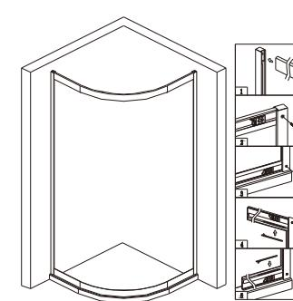
2.将上轨放进墙材槽口,墙材上下机丝锁上,撕掉不干胶垫片的保护膜贴在轨道的固玻位置处(不干胶垫片的长度比固玻宽度短50MM即可)。
