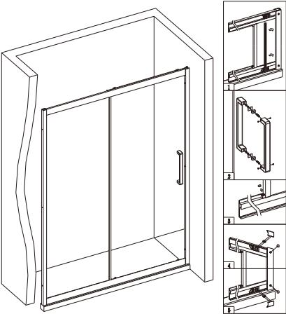
5. 固玻与墙材接触位置打单边胶条；安装拉手；盖上中柱塑件的Ø8装饰盖；盖上墙材上下的Ø10装饰盖；调节开门空间后，装上防撞件的机丝并锁紧，最后盖上防撞件装饰盖。
