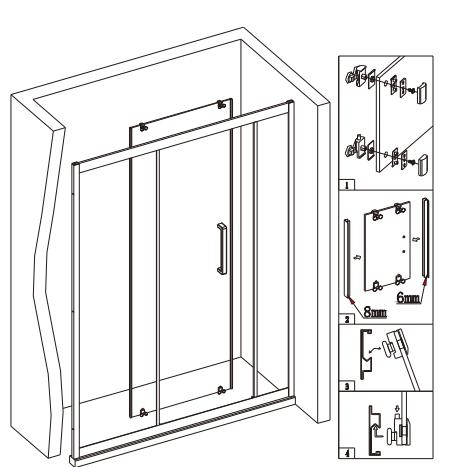
4. 将不锈钢双滑轮分上下安装在活玻上；在活玻两侧装上T型胶条，靠拉手孔边的软边更短(6mm)，另一边软边更长(8mm)，软边朝房体外面；将装好滑轮和胶条的活玻抬起挂在上轨滑槽内，按下下轮的弹簧按钮将下轮卡进下轨滑槽内，调整活玻使滑动顺畅，磁条与胶条等垂直吻合。
