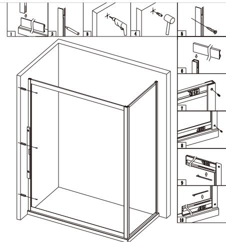
4. 将墙材套在下轨上，调整至合适位置，打水平，钻孔，打膨胀胶粒，将墙材打好螺丝固定在墙上。将上轨放进墙材槽口，墙材上下机丝锁上，撕掉不干胶垫片的保护膜贴在轨道的固玻位置处（不干胶垫片的长度比固玻宽度短50MM即可）。
