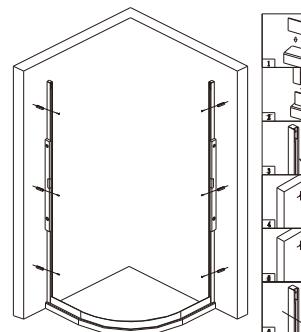
1.首先将下轨放置在石基合适位置,与两条墙材套好。打水平,钻孔,打膨胀胶粒,将两条墙材打好螺丝固定在墙上。
