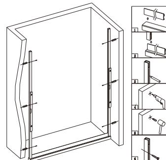
1. 首先将下轨放置在石基合适位置，与两条墙材套好。打水平，钻孔，打膨胀胶粒，将两条墙材打好螺丝固定在墙上。
