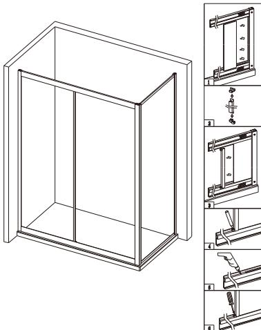
5. 将固玻放在轨道的固玻槽上，推进墙材槽内，调整至合适位置；将中柱塑件跟中柱组装好，按方向卡紧固玻，用铅笔透过塑件的孔位做记号，钻孔，用螺丝将两边的中柱跟上下轨道锁紧固定。
