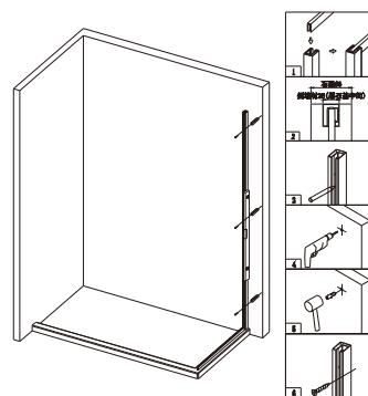
1. 首先将下侧包边卡位卡在侧墙材底部，然后将卡在一起的侧包边和侧墙材一起放到石基上，侧墙材居石基中间，打水平，钻孔，打膨胀胶粒，最后将侧墙材打好螺丝固定在墙上。
