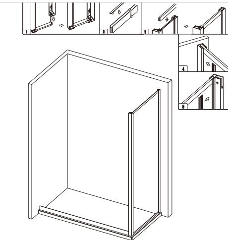
3. 首先将转角卡入下侧包边和下轨的卡口内，然后撕掉不干胶垫片的保护膜贴在另一根上侧包边内的侧固玻槽内（不干胶垫片的长度比固玻宽度短50MM即可），接着将这根上侧包边扣在侧固玻的顶部，两侧分别卡住转角和侧墙材的卡口即可。最后将侧墙材和转角跟侧固玻的相接处打上单边胶条。
