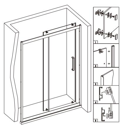
4. 将不锈钢双滑轮分上下安装在活玻上；在活玻的拉手孔边装上胶条，另一边装上F型胶条，软边朝房体外面；将装好滑轮和胶条的活玻抬起挂在上轨滑槽内，按下下轮的弹跳按钮将下轮卡进下轨滑槽内，调整活玻使滑动顺畅，磁条与胶条等垂直吻合。
