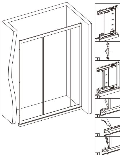
3. 将固玻放在轨道的固玻槽上，推进墙材槽内，调整至合适位置；将中柱塑件跟中柱组装好，按方向卡紧固玻，用铅笔透过塑件的孔位做记号，钻孔，用螺丝将两边的中柱跟上下轨道锁紧固定。
