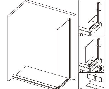
2. 撕掉不干胶垫片的保护膜贴在下侧包边内的侧固玻槽内（不干胶垫片的长度比侧固玻宽度短50MM即可）。然后将下侧包边转角处的卡边掰直，把侧固玻提起放到侧包边的侧固玻槽内，然后推进侧墙材的玻璃槽内，最后再将下侧包边转角处的卡边掰回原状即可。将下轨放置在石基的合适位置。
